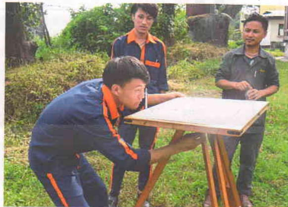
図1：JNEC の研修現場での平板測量 5)
